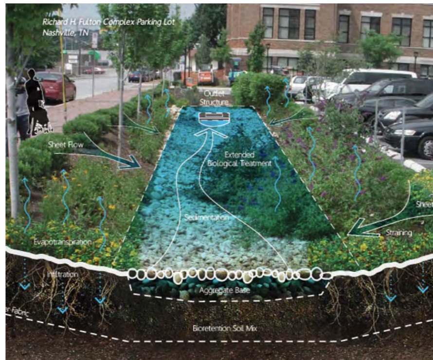
Kuva 20 Hulevesien imeytys- ja viivytyalueet voidaan suunnitella monipuolisiksi pihan viherelementeiksi. (kuvat: ylhäällä vasemmalla: Mayot & Toussaint (kuvaa muokattu), ylhäällä oikealla: GreenWorks, Russellville Commons, alhaalla: Low Impact Development, Opportunities for the PlanET region by University of Tennessee)
